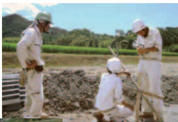
2日目は前日と同じ場所、トータルステーションを用いて角度と距離と高さを測量しました。現場で測量してみると、地面が硬かったり、柔らかかったり、斜面だったりして、機械を据えるだけでも大変でしたが、スムーズにできる機械の据え付け方を指導していただきました。
