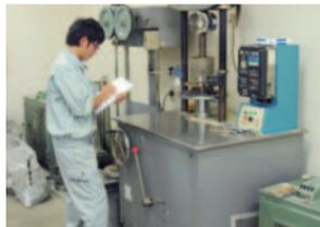
現場実習では、主に土質について教えてもらいました。最初にCBR試験について説明を受けて実験をしました。さらに手順を確認し、翌日に向けて締め固め試験と含水比試験の準備を行いました。その後、土の粒度試験を行い、土の粒径による性質の違いやその名称、その他の土質に関する室内試験の内容やその利用法についてなど詳しく教えてもらいました。土は土木工事の基礎を築くものなので、慎重で正確な調査をもとに工事が進められていることがよく分かりました。
