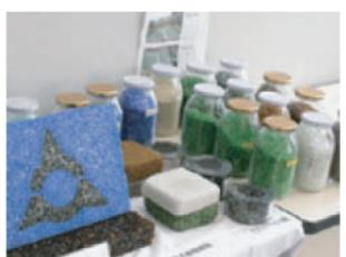
空き瓶などの廃ガラスを安全で無害な状態に加工処理し、道路のアスファルトなどに使う砂の代替品として再利用する商品です。またこのガラスビーズを固めた
