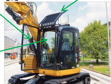
運転室周りの飛来物防護設備の例
